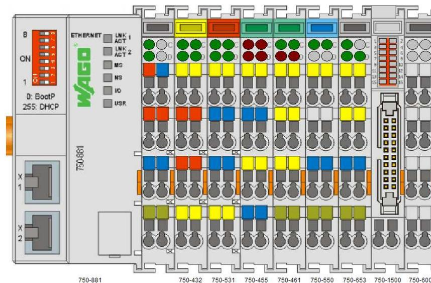
La borne d'interface série est configurée en 5 octets, et occupe donc 3 mots d'entrée (5 octets de données + un octet d'état) et 3 mots de sortie (5 octets de données + un octet de contrôle). Cette interface série étant placée après les entrées analogiques, ses 3 mots d'entrée seront placés après ceux des entrées analogiques, et avant les bits des entrées TOR.
